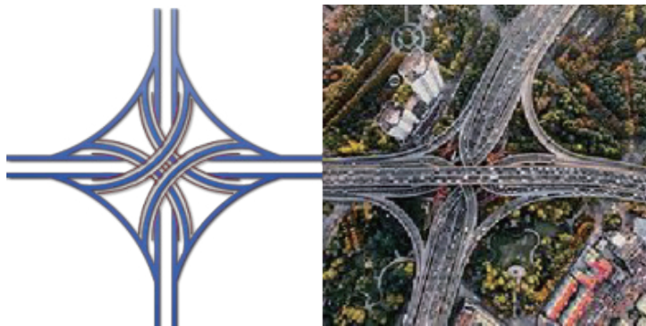
图 3. (a) 环状型立交桥的布局 (b) 上海延安东路的环状型立交桥
